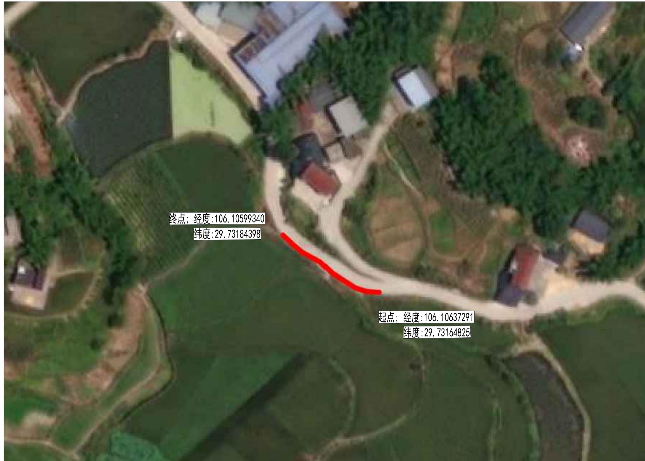
注: 本段安全护栏设置在道路左侧, 布设长度40米, 路面宽4.5米
