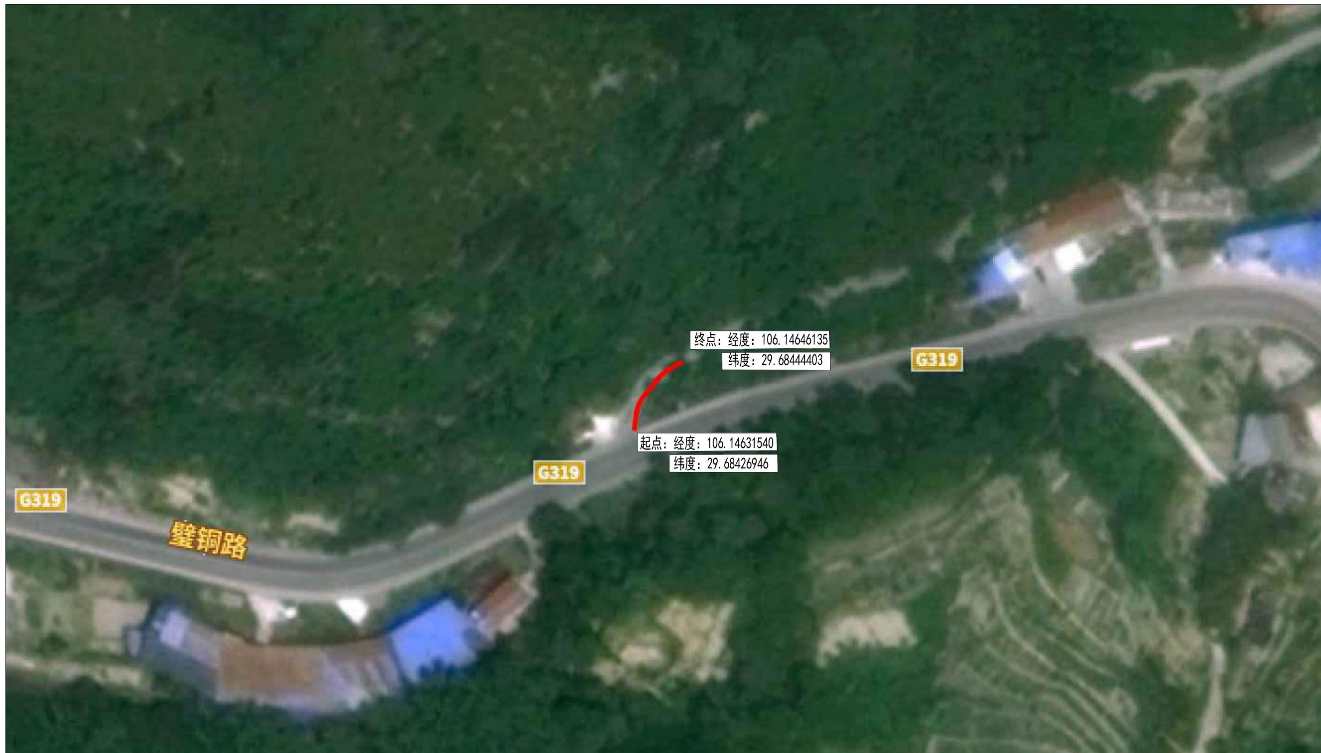
注：1. 本段安全护栏设置在右侧，长24米，路面宽4.5米；
