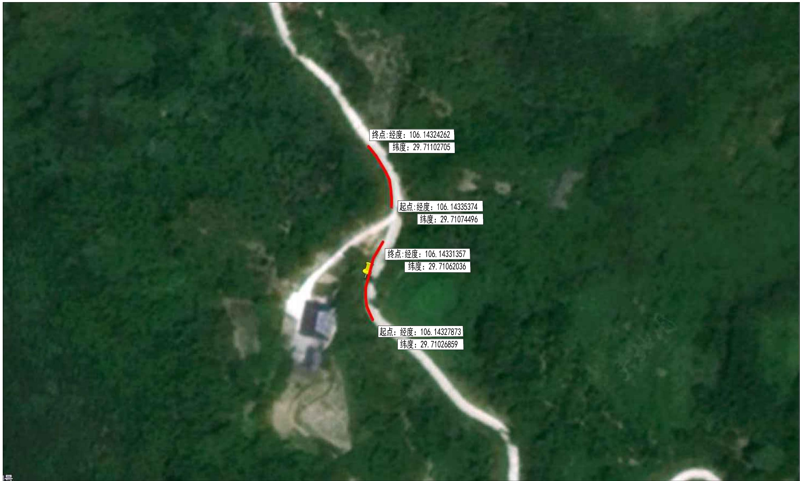
注：1. 本段安全护栏设置在两处，两处共计72米，设在左侧，第一处长40米，第二处长32米，路面宽4.5米；
