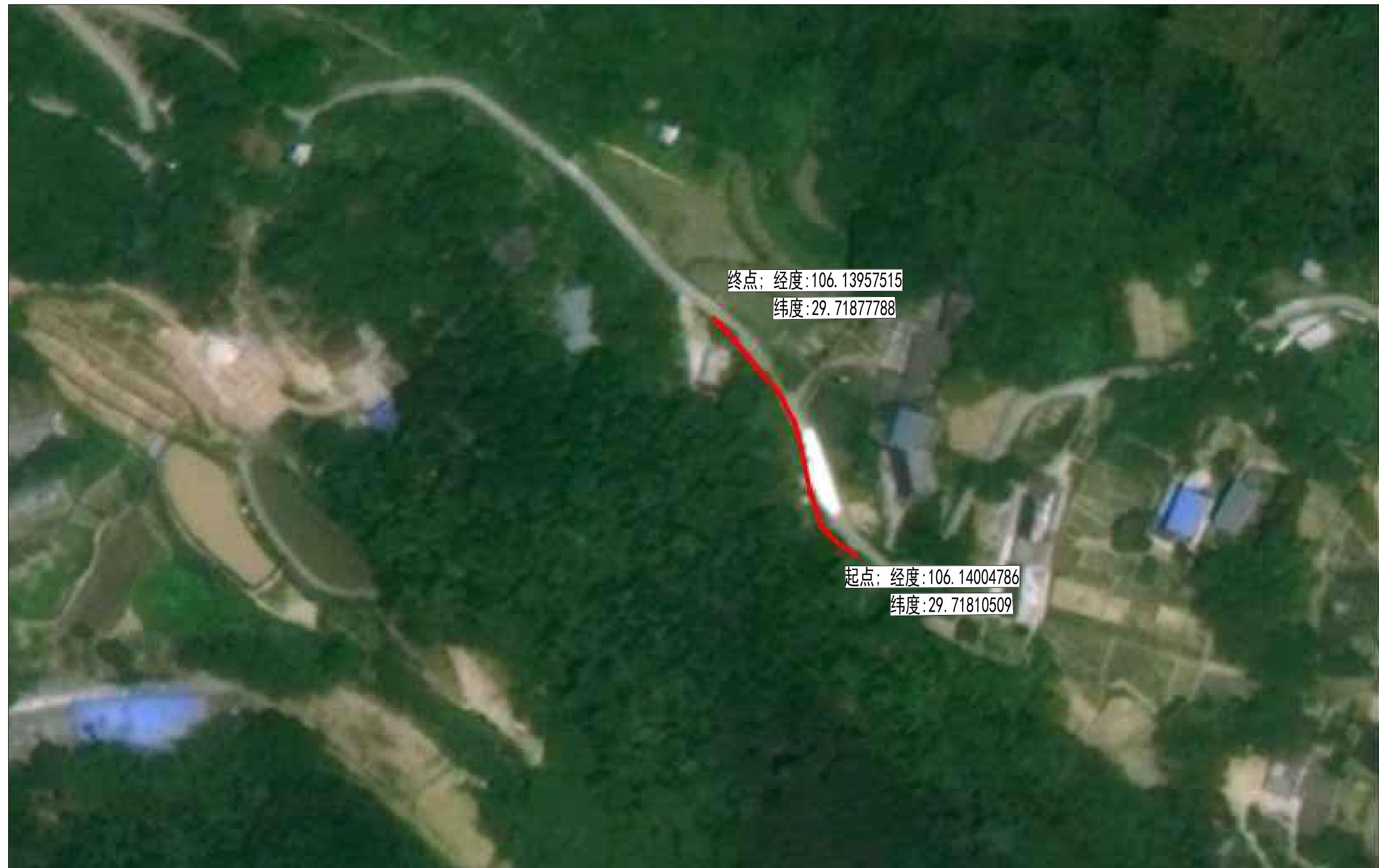
注：本段安全护栏设置在道路左侧，长度88米，路面宽4.5米
